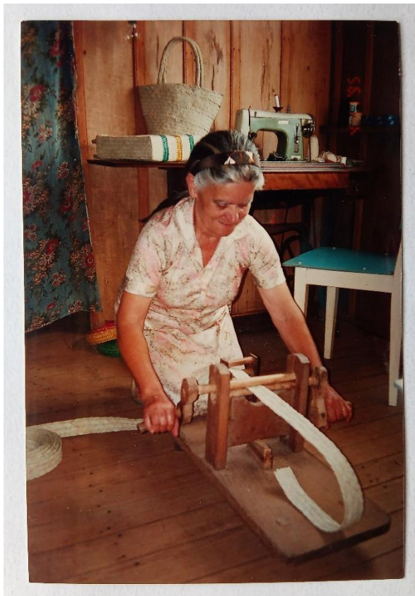
Figura 16 - Descaroador adaptado para prensar as tranças do arquivo pessoal de Dona Verônica.
