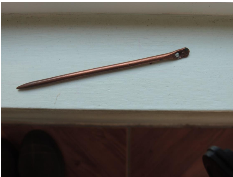
Figura 14 - Agulha grossa para costura feita manualmente a partir de um fio de cobre.
